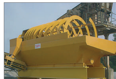
Рис.4 Уловитель песка типа SF – X
