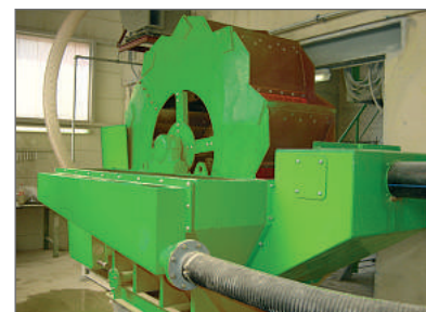
Рис.2 Черпальное колесо типа SR
