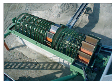
Рис.5 Двойной уловитель песка типа SFD – ML
