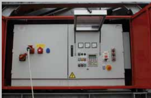
Шкаф управления герметично изолирован от воздействий окружающей среды
