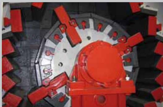
Особая геометрия дробильной камеры - 7 зон дробления
