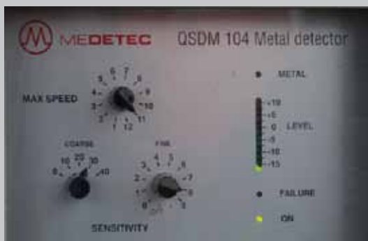
Устройство обнаружения металла - чувствительность регулируется
