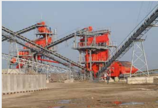
Стационарный дробильно-сортировочный комплекс производительностью 250 т/ч
