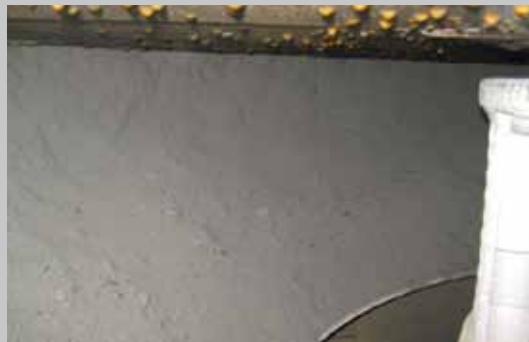
Принцип самоизмельчения «камень о камень», образование самофутеровки
