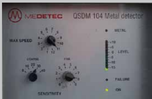
Устройство обнаружения металла - чувствительность регулируется
