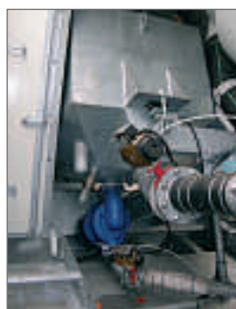
Рис. 3 Двухкамерные весы воды с насосом для впрыска
