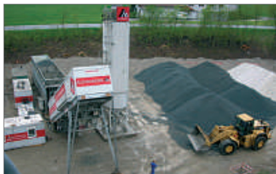
Рис. 1 Бетоносмесительная установка EUROMIX с дозатором и складом минералов
