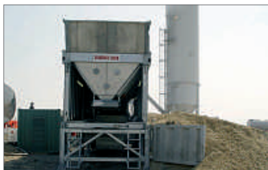
Рис. 2 Мобильный дозатор с пандусом, уложенным непосредственно к стальной конструкции
