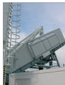
Рис. 4 Силос цемента со шнеком
