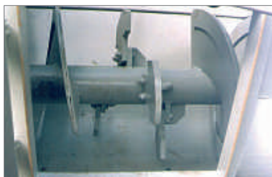
Рис. 3 Промывочный шнек для отделения минералов
