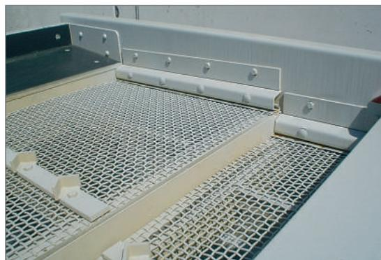
Рис.4 Поперечное натяжное сито из стали с крепёжными элементами
