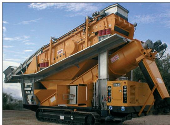
Рис.2 Шнеки для удаления воды из песка
