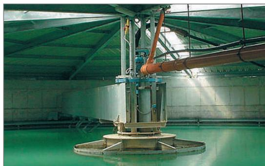
Рис.4 Радиальный сгуститель для экономного использования воды
