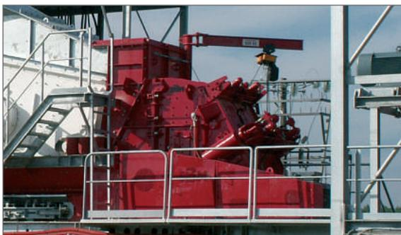
Рис.1 Горизонтальная роторная ударно-отражательная дробилка
