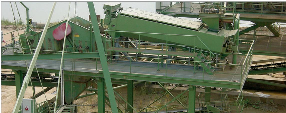
Рис.1 Лопастные мойки для очистки материала
