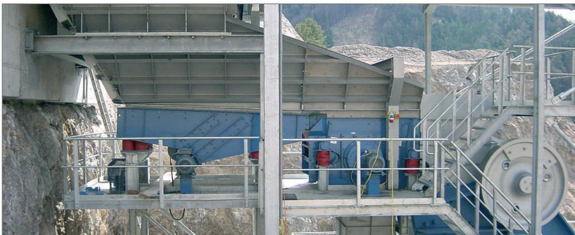
Рис.1 Питатель с грохотом предварительного отсеивания
