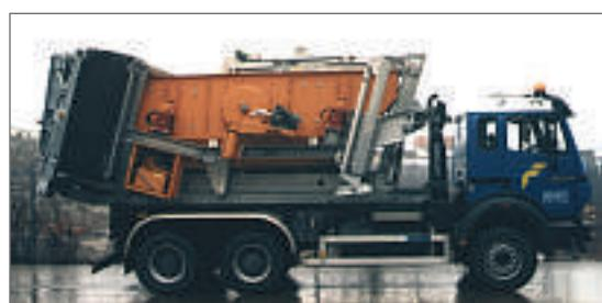
Рис. 3 Контейнерный виброгрохот CM 14/38-1, компактный, мобильный, быстро транспортируемый
