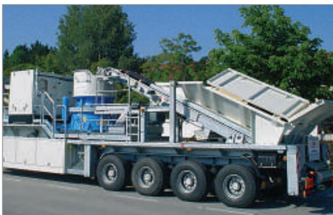
Рис. 2 Конусная дробилка на колёсном шасси при транспортировке
