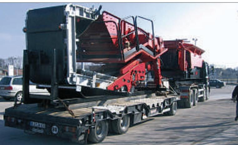
Рис. 1 remax 1318 E/D SII транспортировка модуля грохота и загрузочного бункера
