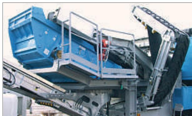
Рис. 3 Стандарт: Откидной конвейер с поворотным зубчатым приводом и оцинкованной рамой
