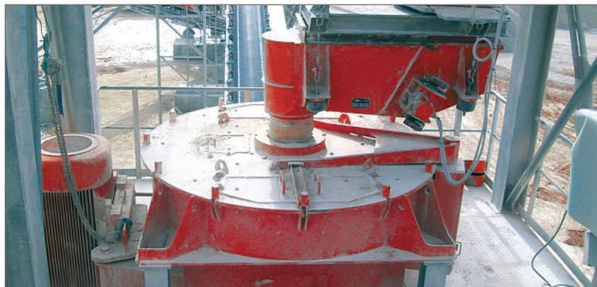
Рис.1 Multipactor с загрузочной воронкой в работе
