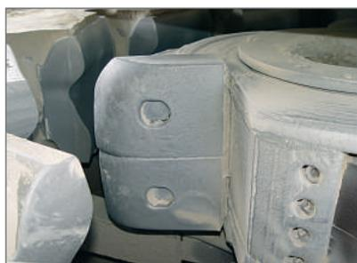
Рис.2 Ротор с ударными билами и ударно-отражательным кольцом
