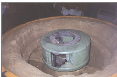
Рис.3 Ротор V8 со стенкой из перерабатываемого материала
