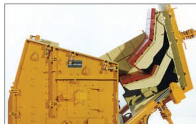
Рис.3 Ударно-отражательные плиты
